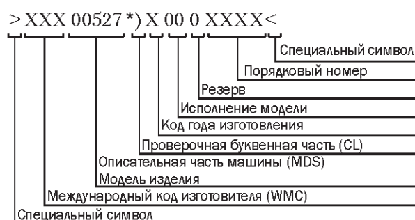
Рисунок 1.2 – Маркировочная табличка машины и расшифровка идентификационного номера: *) Проверочная буквенная часть (CL) рассчитывается математически или используется буква N без расчета
